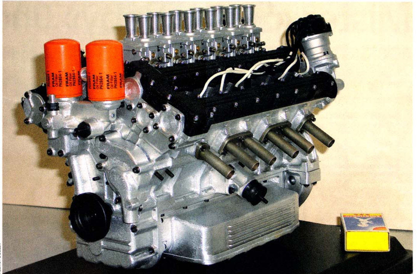
Das Prachtstück der Modellmanufaktur R. Luther ist zweifellos dieser V12-Motor: 6 Doppelvergaser, 4 oben liegende Nockenwellen, 2 Zündverteiler, verbreiterte Ölwanne für grösseres Volumen. Hubraum 72 cm 3 , Länge 220 mm, Breite 180 mm, Höhe 180 mm.
